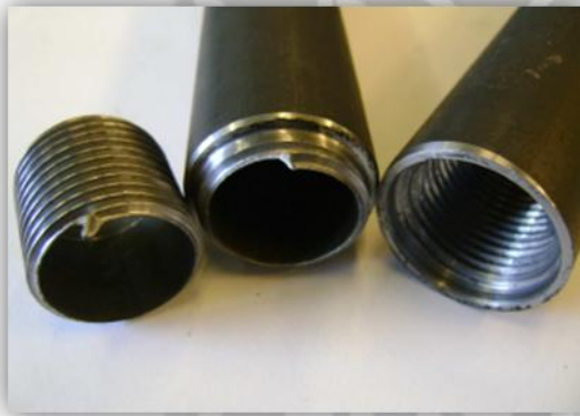
Zona de fractura
